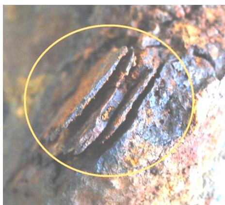
Рисунок 6 Пластинчатое (кристаллическое) расслоение окисленной металлической матрицы тела
