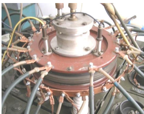
Рисунок 3 Электродная система ПФ и вакуумный разрядник установки КПУ–30
